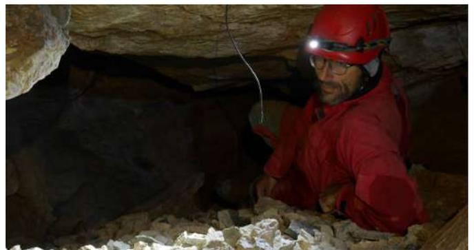
Installazione di sensori per misurare temperature della roccia a diverse profondità (100-50-20 cm).
